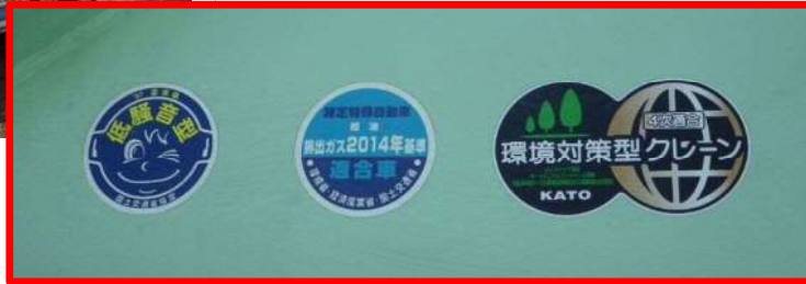
排出ガス対策・振動の措置された重機(クレーン)の使用
