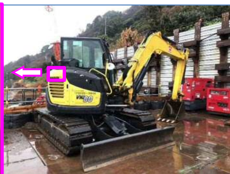
オートデセル：自動ローアイドル状態機能付き(ペダルと連動)のバックホウの使用
