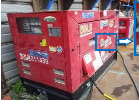
排出ガス対策・振動の措置された発電機
