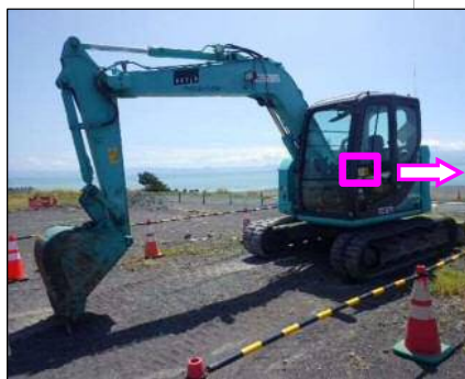
アイドリングストップ機能付き(乗降遮断式レバーと連動)のバックホウの使用
