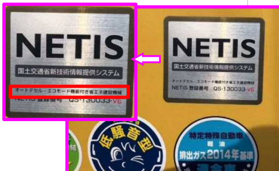
オートデセル：自動ローアイドル状態機能付き(ペダルと連動)のバックホウの使用
