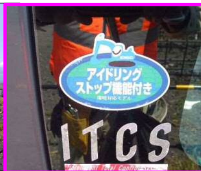
アイドリングストップ機能付き(乗降遮断式レバーと連動)のバックホウの使用
